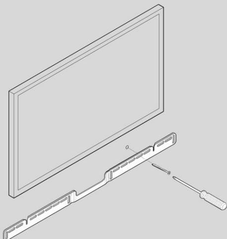
4. Coloca el soporte de pared sobre los puntos marcados para los tornillos con la ayuda de un nivel. Utiliza un destornillador de estrella o un taladro eléctrico para atornillar el soporte a la pared. Asegúrate de que las flechas del centro apuntan hacia arriba.
