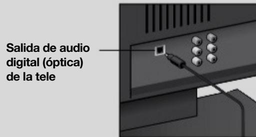
**IMPORTANTE:** Retira las tapas protectoras de cada extremo del cable de audio óptico antes de insertarlo.
