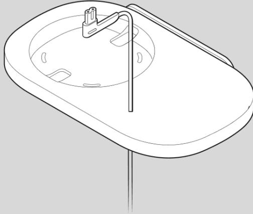
6. Alinea las clavijas con cuidado y presiona la cubierta inferior firmemente contra el estante hasta que encaje. Conecta el cable de alimentación al altavoz y coloca el altavoz sobre el estante.
