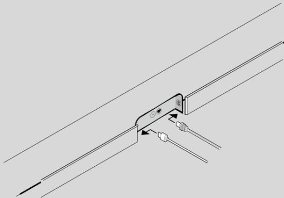
6. Conecta el cable de alimentación y el cable HDMI a la parte posterior de la barra de sonido.
