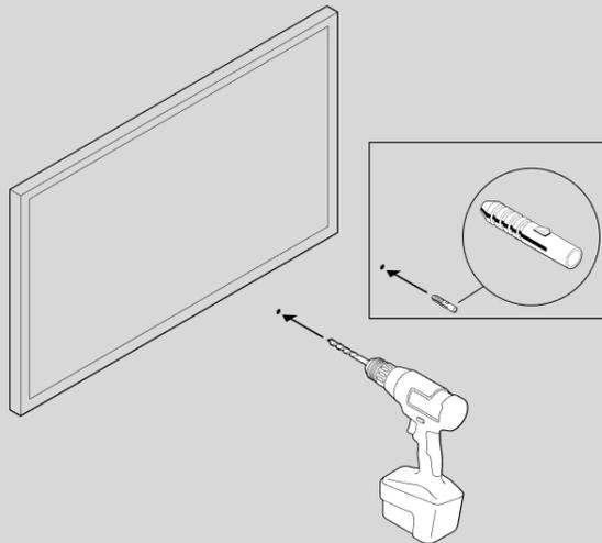
3. Si usas los anclajes de pared que van incluidos, usa una broca de 5/16" para perforar los orificios guía y luego inserta los anclajes. No uses los anclajes para perforar madera o plástico.
