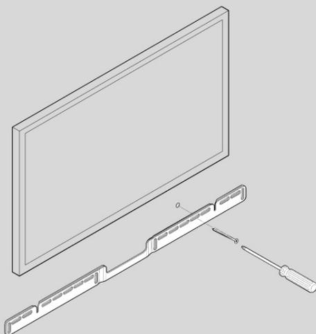
4. Coloca el soporte de pared sobre los puntos mArc SLados para los tornillos con la ayuda de un nivel. Utiliza un destornillador de estrella o un taladro eléctrico para atornillar el soporte a la pared. Asegúrate de que las flechas del centro apuntan hacia arriba.
