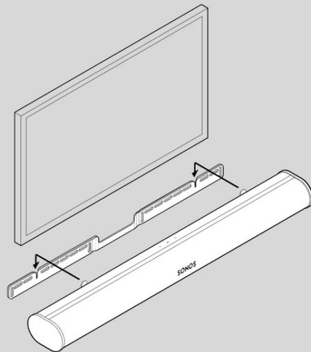
7. Desliza la barra de sonido hacia abajo para que los pernos encajen en las ranuras del soporte de pared. Asegúrate de que los controles táctiles están hacia arriba y de que la barra de sonido está bien apoyada.
