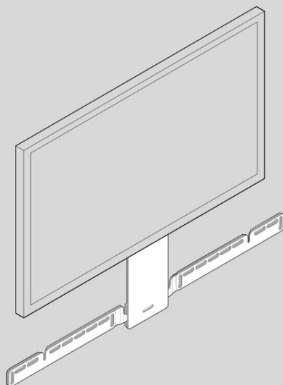
1. Si la tele está montada en la pared, pon la guía contra la pared y alinea el borde superior con la parte inferior de la tele. Debes dejar un espacio de 14 cm entre la parte superior de la soporte de pared y la tele.
