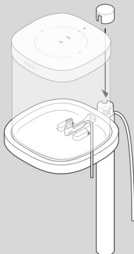
6. Presiona el cable de alimentación hacia el eje, desde arriba hacia abajo. Tira del cable sobrante hacia abajo desde la base.
