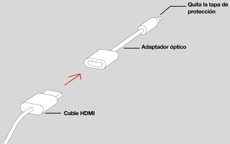
3. Conecta el adaptador óptico al puerto de **salida digital óptica** de tu tele.
