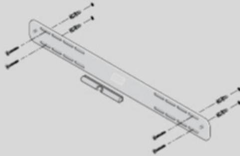
6. Coloca el soporte sobre la pared y aprieta un poco los tornillos para sujetar el soporte. Comprueba que está bien nivelado y aprieta los tornillos.
